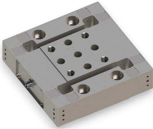
Der 3-Achssensor K3D400 eignet sich für die Kraftmessung in drei zueinander senkrechten Achsen. Die Krafteinleitung erfolgt auf dem Absatz 200mm x 200mm. Auf dieser Fläche kann ein Bauteil mit vier Schrauben M30 verbaut werden. Die Unterseite des Sensors wird mit vier Schrauben M30 an der Unterseite befestigt. Die Anschraubflächen müssen plan mit dem Sensor abschließen.
