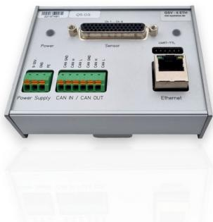
Der Messverstärker GSV-6H6 CAN/SubD44HD ist ein 6-Kanal Messverstärker für Dehnungsmessstreifen mit CAN Schnittstelle, sowie mit Ethernet und UART Port 3.3V. Der Anschluss von Sensoren mit Dehnungsmessstreifen Vollbrücken erfolgt über die SubD44HD Buchse. Durch die SubD44HD Buchse eignet sich der GSV-6H6 zum Anschluss von Kraft-/Momenten Sensoren.
