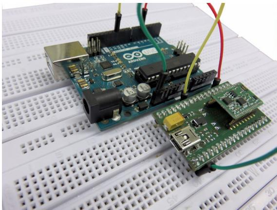
Das Development Board ist ausgestattet mit zwei Buchsenleisten im Rastermaß 1mm zur Aufnahme eines GSV-6CPU;
