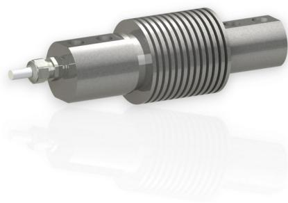
Der Kraftsensor KD120 ist für eine maximale Einsatztemperatur von 180°C ausgelegt. Die Krafteinleitung an den zylindrischen Enden erfolgt wahlweise durch Klemmen oder mit 4 Schrauben M8.
