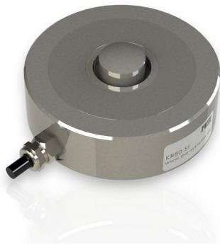
Die Wägezelle KR80 ist eine Präzisions-Wägezelle in zylindrischer Ausführung. Sie ist hermetisch dicht verschweißt und in eichfähiger Ausführung entsprechend den europäischen Anforderungen nach OIML R-60 bis Klasse C6 verfügbar. Sie zeichnet sich durch einen besonders geringen Messweg von nur 0,1mm aus.
