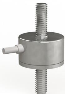
Der KM10z ist ein Membran-Kraftsensor in Ultraminiatur-Ausführung für Zug- und Druckkraft-Messung. Die Krafteinleitung erfolgt über zwei Gewinde M2,5. Bei der Krafteinleitung muss sichergestellt werden, dass keine Biegemomente größer als 0,1 Nm eingeleitet werden.
