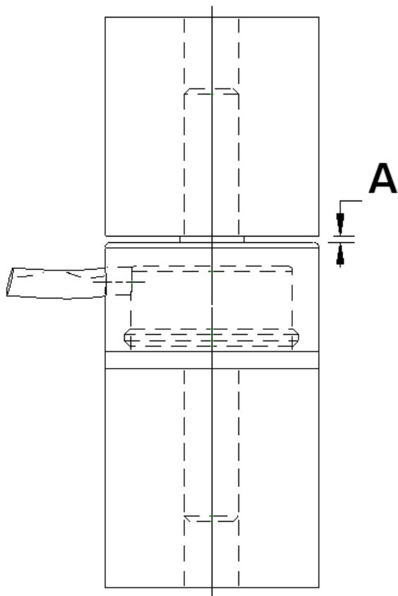
Spalt „A“ darf nicht überbrückt werden, Spalt „A“ ist erforderlich für die Funktion des Kraftsensors.
