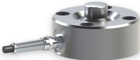
Der Kraftsensor KM90 ist ein Membran-Kraftsensor zur Messung von Druckkräften. Der Kraftsensor wird mit vier Schrauben M8 von oben auf einer ebenen Fläche mit M8 Gewindebohrungen befestigt. Alternativ wird der Sensor von Unten mit 4 Schrauben M10 befestigt. Für die Krafteinleitung ist eine Kalotte mit Radius 100 mm vorgesehen.
