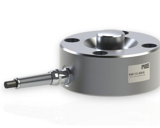
Der Kraftsensor KM115 ist ein Membran-Kraftsensor zur Messung von Druckkräften. Der Kraftsensor wird von der Unterseite mit vier Schrauben M12 auf einer ebenen Fläche befestigt.
