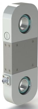
Kraftmesslaschen sind ideale Kraftsensoren zur Messung von großen Lasten. Daher werden diese hauptsächlich in Kränen und anderen seilbetriebenen Hebesystemen zur Messung der Zugkraft eingesetzt. Die Kraftmesslaschen wurden speziell für den Einsatz unter rauen Umgebungsbedingungen konstruiert.
