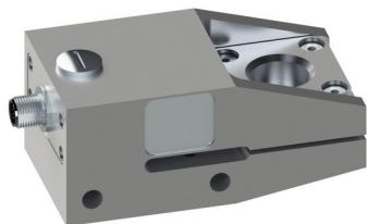
Der Kraftsensor KD115u eignet sich besonders zur Messung der Kontaktkraft zwischen zwei Elektroden eines Punktschweißgerätes. Der Abstand zwischen den Elektroden kann in einem Bereich von 5mm bis 20mm angepasst werden. Im Lieferumfang sind Adapter mit einer kreisförmigen Druckfläche Durchmesser 22mm enthalten.
