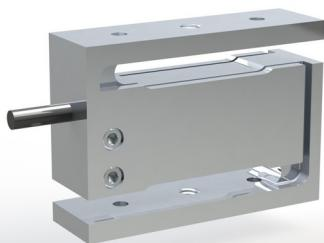
Der Kraftsensor KD34s wurde speziell zur Messung kleinsten Kräfte ausgelegt. Durch den integrierten Anschlag gegen Überlast ist dieser Kraftsensor auch im Messbereich 0,25N und 0,5N noch sicher in der Handhabung. In der Ausführung für 0,25N werden spezielle Dehnungsmessstreifen aus einer Platin-Nickel Legierung eingesetzt mit einer um den Faktor 2 höheren Empfindlichkeit gegenüber herkömmlichen Dehnungsmessstreifen aus Konstantan.
