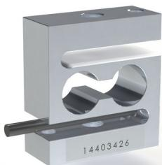
Der Kraftsensor KD24S ist ein universell einsetzbarer Kraftsensor in S-Form. Er eignet sich hervorragend für Prüfaufgaben in der Qualitätssicherung sowie in der Werkstoffprüfung. Krafteinleitung und Kraftausleitung sind zentrisch angeordnet. Die Krafteinleitungsbügel werden bei Belastung parallel verschoben.
