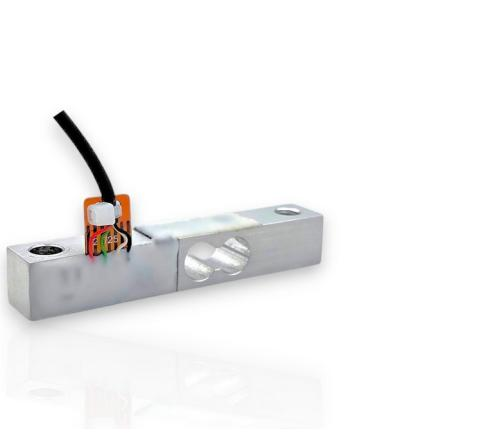
Der Kraftsensor KD60 hat die Geometrie einer Miniatur-Wägezelle. Der Kraftsensor wird über die Durchgangsbohrungen ø5,3 einseitig befestigt. Die Krafteinleitung erfolgt in das Gewinde M5. Die Krafteinleitung wird bei Belastung parallel verschoben. Verschiebungen des Krafteinleitung und Querkräfte toleriert der Kraftsensor aufgrund seiner Ausführung als Doppelbalken.
