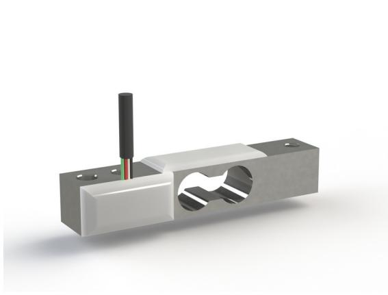
Der Kraftsensor KD45 hat die Geometrie einer Miniatur-Wägezelle. Der Kraftsensor wird über die Durchgangsbohrungen ø3,2 einseitig befestigt. Die Krafteinleitung erfolgt in das Gewinde M3.
