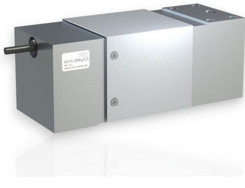
Der Kraftsensor KD191 wird eingesetzt in Plattformwaagen und in Prüfständen. Er erlaubt die Montage einer Plattform zur Krafteinleitung in der Größe von 900 x 900mm (bzw. 600mm x 600mm für den Messbereich 1000kg).
