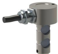
Der Messbolzen KB16x32 eignet sich zur Messung der Kraft z.B. in Verbindung mit einem Gabelkopf G16x32 nach DIN 71152 / DIN ISO 8140.
