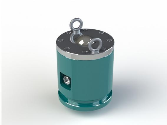
Die Kraftsensoren der Serie KA224 eignen sich für den Einsatz unter rauen Bedingungen. Das robuste Sensorgehäuse kann Querkräfte bis zu 100% der Nennkraft aufnehmen. Die Schutzart ist IP67. Die Einsatztemperatur darf bis zu 120°C betragen. Zum Transport können zwei Ringmuttern eingesetzt werden. Der Anschluss erfolgt über einen M23 Steckverbinder in 6-Leitertechnik.
