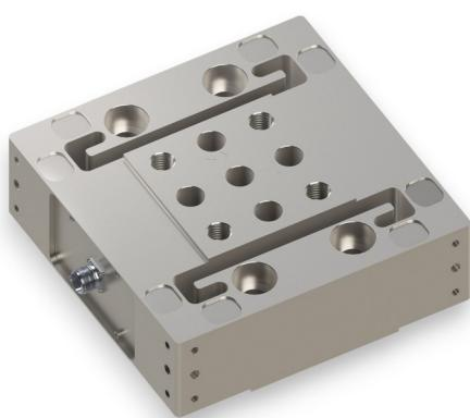
Der 3-Achssensor K3D300 eignet sich für die Kraftmessung in drei zueinander senkrechten Achsen. Die Krafteinleitung erfolgt auf dem Absatz 150mm x 150mm. Auf dieser Fläche kann ein Bauteil mit vier Schrauben M24 verbaut werden. Die Unterseite des Sensors wird mit vier Schrauben M24 an der Unterseite befestigt. Die Anschraubflächen müssen plan mit dem Sensor abschließen.
