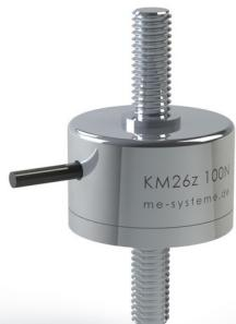
Die Kraftmessdose KM26z ist ein Membran-Kraftsensor mit kleinen Abmessungen, der zur Messung von Zug- und Druckkräften eingesetzt wird. Für die Krafteinleitung sind zwei Gewinde M6 vorgesehen. Die Schutzart ist IP 67. Die Krafteinleitung muss frei von Querkräften und Biegemomenten erfolgen.
